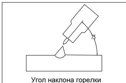
Рис. 7-1-15: Угол наклона горелки
