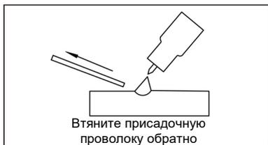
Рис. 7-1-17: Втягивание присадочной проволоки
